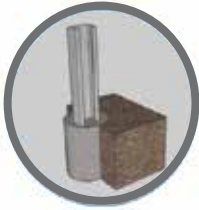
Ön Delgi ve/veya Beton Uygulama
